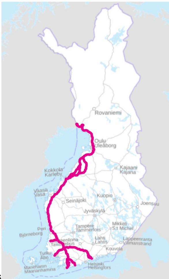
Kuva 5. Gasgrid Finland Oy:n suunnittelema vetyputkiverkosto Suomessa (Gasgrid, 2025).
